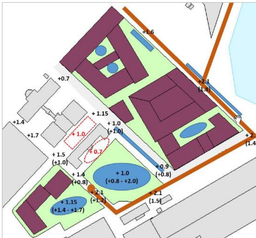
Höjder inom planområdet. I områden där åtgärder kommer innebära förändrad höjdsättning visas nuvarande höjder inom parentes. Höjder på södra Planetgatan samt inom skolområdena relaterar till lägsta bottennivåer på skyfallsytorna. Röd streckade områden beskriver lågpunkter omkring Gothiahuset med begränsad möjlighet till förändrad höjdsättning.
